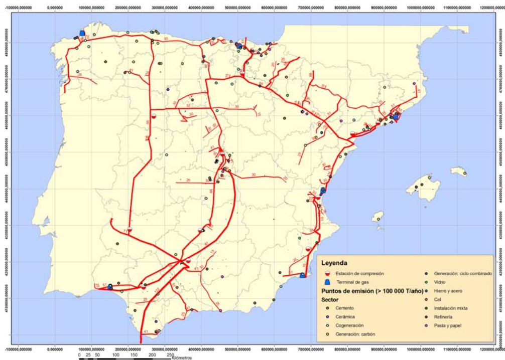
Figura 3: Mapa con las principales fuentes de emisión de CO 2 (>100 000 t/año) e infraestructuras de transporte. (IGME, Grupo de Almacenamiento de CO 2 , 2007)
